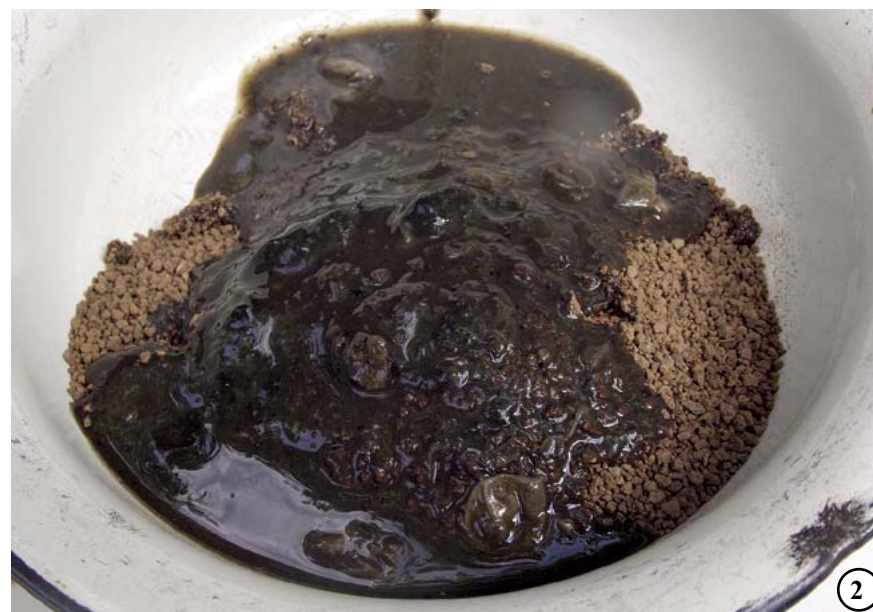
Илл. 31. Подготовка компонентов формовочных масс: 1 – процесс варки рыбьего клея; 2 – составление ФМ с рыбьим клеем
