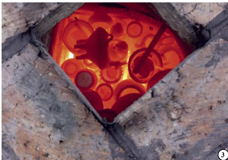
Илл. 58. Процесс обжига в горне и печи: 1 – обжиг в горне; 2 – имитация печного обжига в горне (разведение огня непосредственно в обжиговой камере вместе с закладкой сосудов); 3 – свечение сосудов в горне
