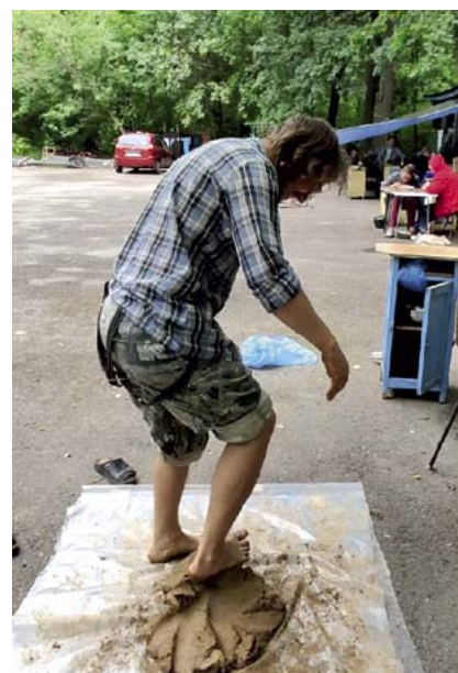
Илл. 29. Подготовка компонентов формовочных масс: 1 – дробление шамота камнем; 2 – проминание формовочной массы
