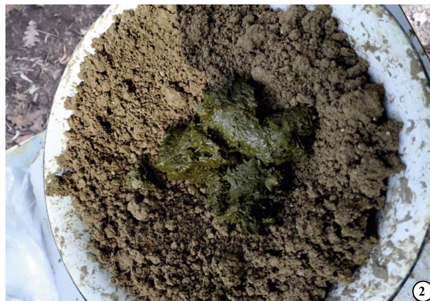
Илл. 27. Компоненты формовочных масс, вводимые в ее состав в естественном состоянии: 1 – пух болотных растений (рогоз); 2 – навоз коровы в естественном влажном состоянии.
