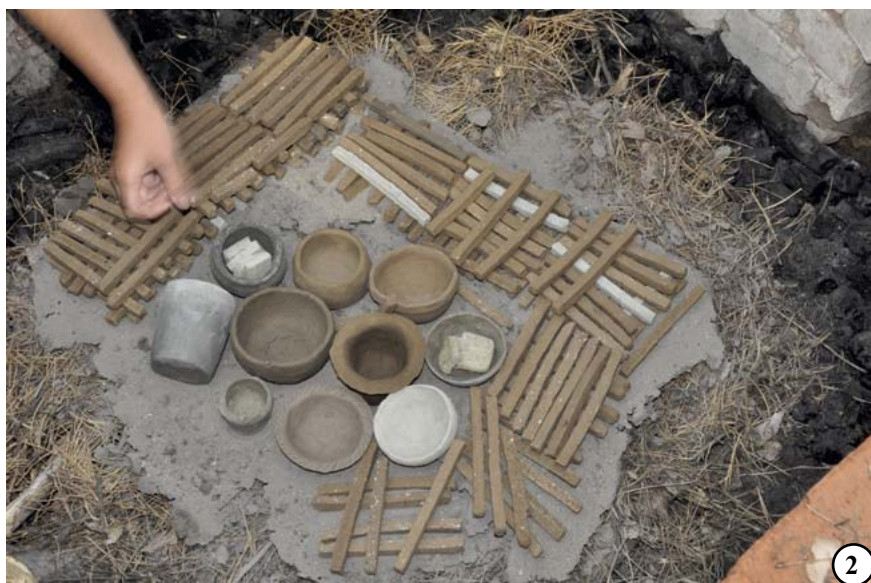
Илл. 12. Изготовление эталонов по пластичному сырью и формовочным массам в СЭИДГ: 1 – изготовление эталона с помощью специальных формочек, их маркировка; 2 – вид эталонов во время сушки
