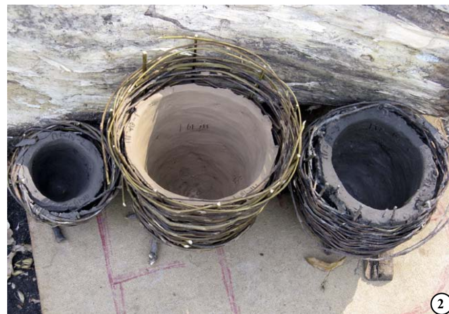
Илл. 7. Эксперимент по обмазыванию и обжигу корзин в 2019 г.: 1 – процесс обмазывания корзины илом; 2 – сушка готовых изделий
