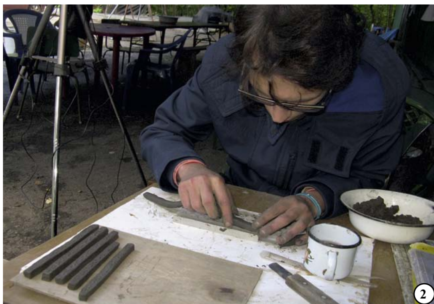
Илл. 16. Подготовка илов: 1 – вид комков ила, очищенных от крупных растительных включений (кучка справа); 2 – изготовление эталонов из ила в формочках
