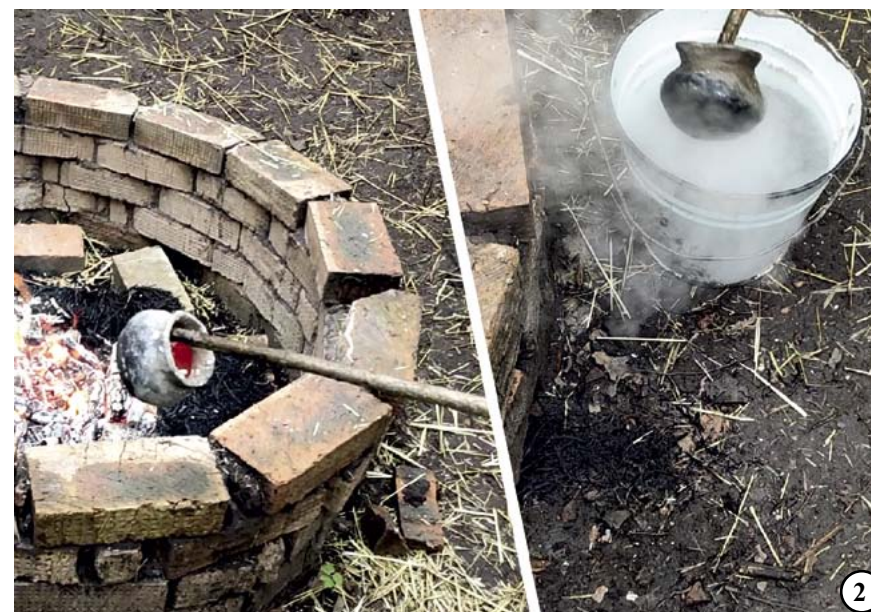
Илл. 59. Процесс химико-термической обработки сосудов: 1 – обваривание в мучном растворе; 2 – закаливание в воде
