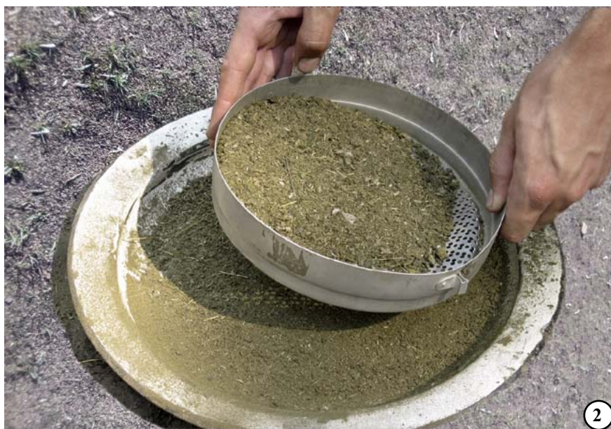
Илл. 30. Подготовка компонентов формовочных масс: 1 – разминание сухого навоза; 2 – просеивание навоза
